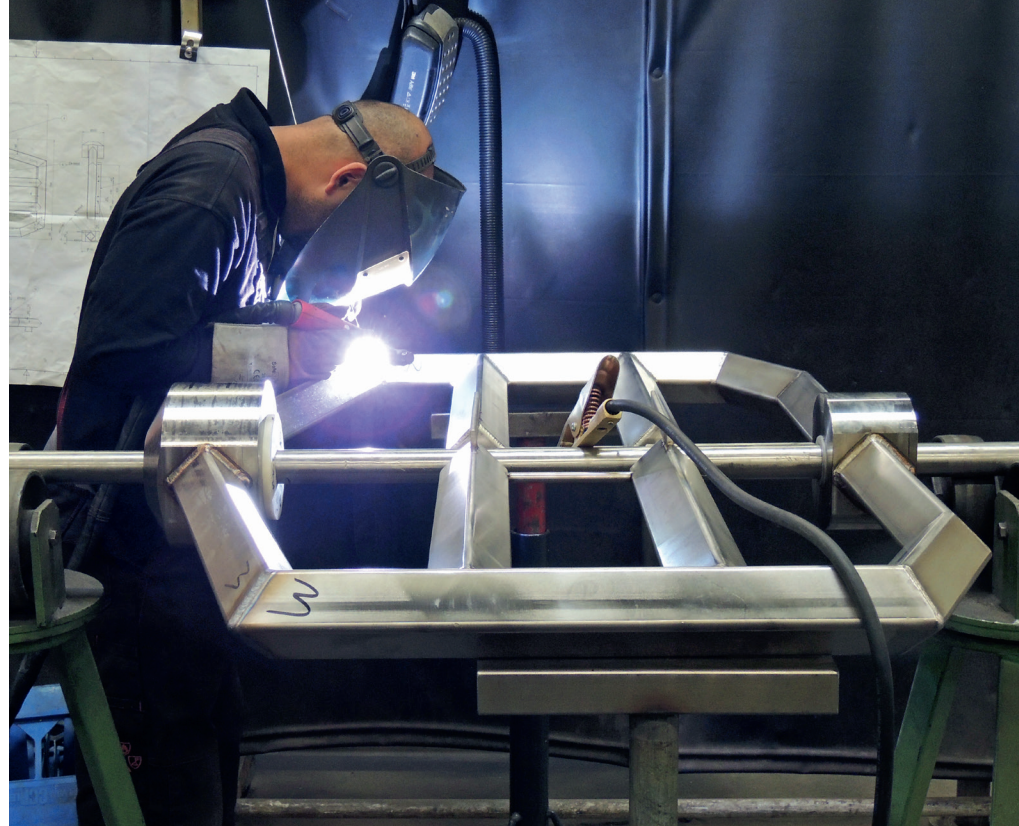
Het lassen van roerwerk.
